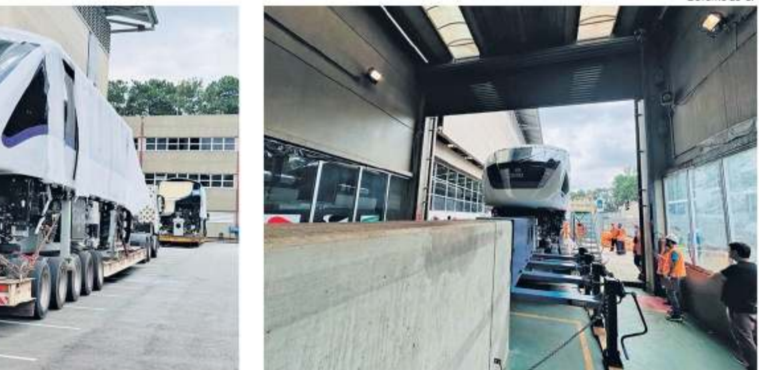
Carros são retirados das carretas e colocados nas vigas por um braço mecânico para a realização da montagem
