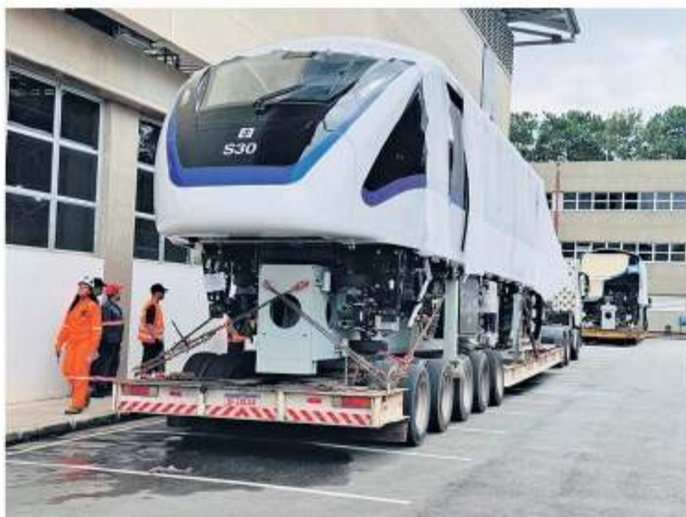
Carros são retirados das carretas e colocados nas vigas por um braço mecânico para a realização da montagem
